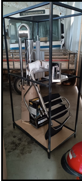
Cadeira Hidromecânica para acessibilidade na piscina.
